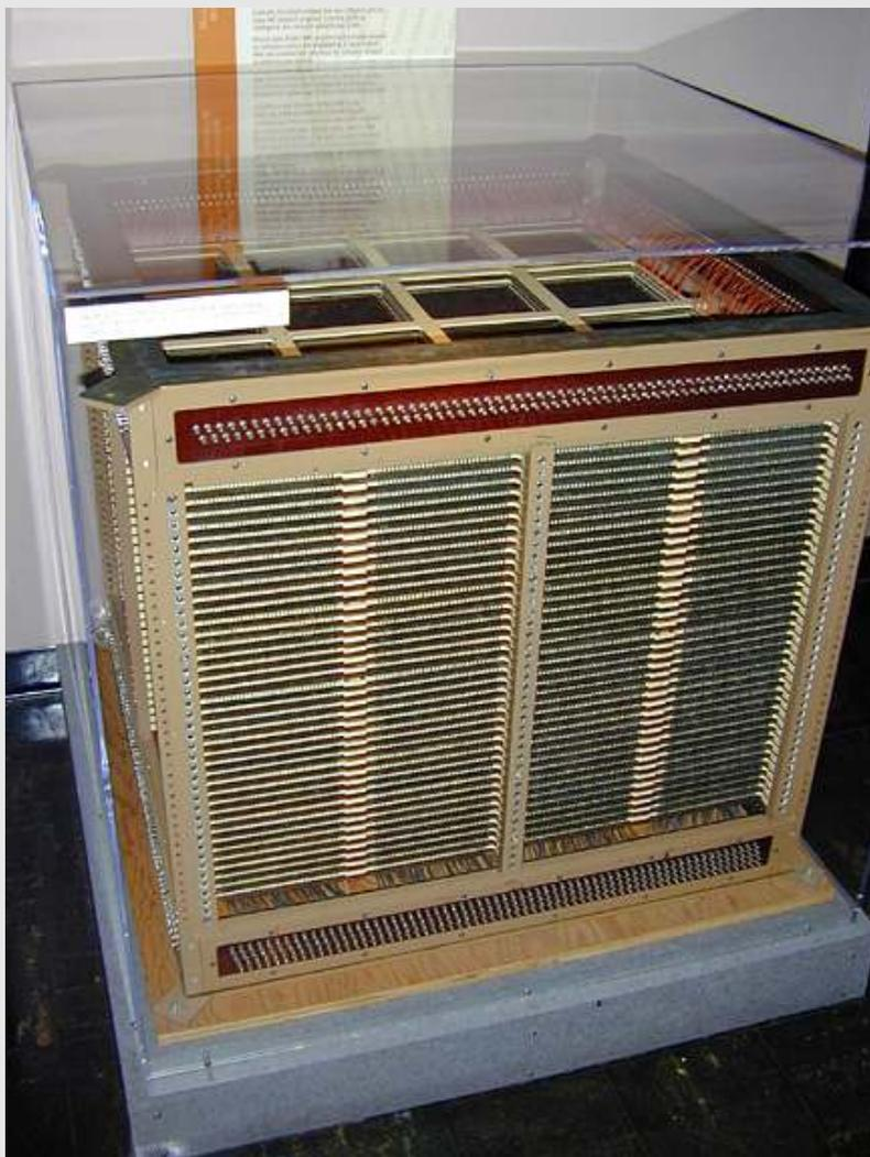
Por serem muito caras e precisares de um grande número de circuitos de apoio, as memórias core ficaram restritas aos computadores de grande porte. O Altair já utilizava memórias "modernas" na forma de chips, para ser exato, dois chips de 1024 bits (ou 128 bytes) cada um.
