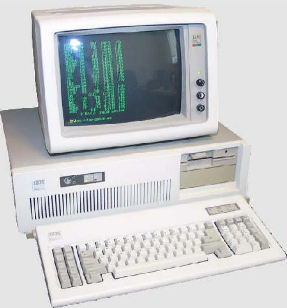
O PC AT vinha com um processador 286 de 6 MHz (depois surgiram versões mais rápidas, de 8, 12 e até 16 MHz),
