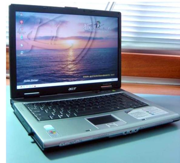
Ele usa uma bateria Li-ion de 6 células, que fornece 4000 mAh a 11.1V. A tensão nominal das células Li-ion é 3.6V, mas isso varia sutilmente de acordo com a tecnologia usada. Para chegar aos 11.1V, foram utilizadas células de 3.7V, onde temos as células distribuídas em duas séries de 3 células ligadas em série.
