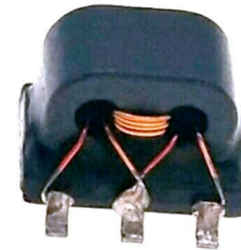
Transformador de rádio-frequência
