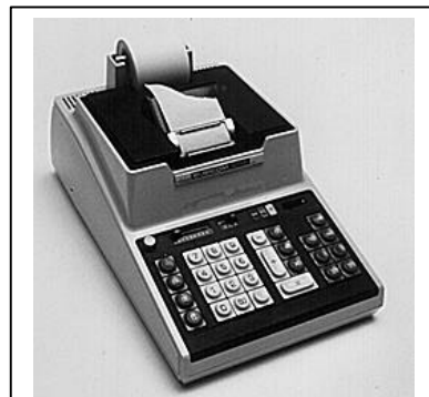
A calculadora Busicom de 1970, empregando o microprocessador Intel 4004.
