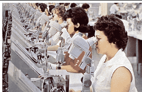
Linha de montagem de transistores da Motorola em 1961. Os transistores tinham que ser testados e montados um a um em seus invólucros metálicos.
