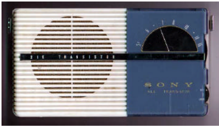
Rádio Sony modelo TR-608 de 1958, com seis transistores e já utilizando o logotipo com o qual a empresa ficou mundialmente conhecida.
