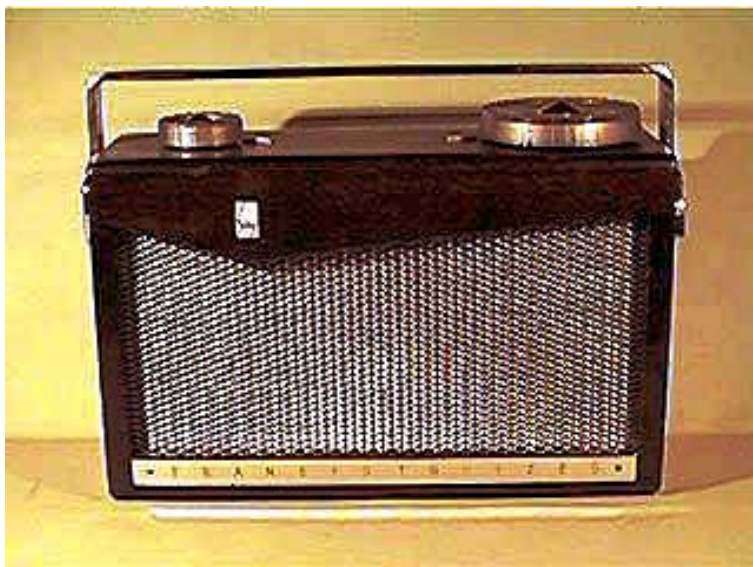
Rádio transistorizado modelo TR-1 fabricado pela empresa Regency nos EUA em 1955, utilizando quatro transistores da Texas Instruments.
