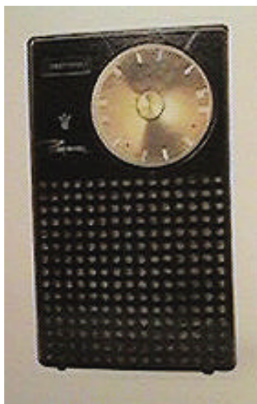
Rádio transistorizado modelo TR-1 fabricado pela empresa Regency nos EUA em 1955, utilizando quatro transistores da Texas Instruments.
