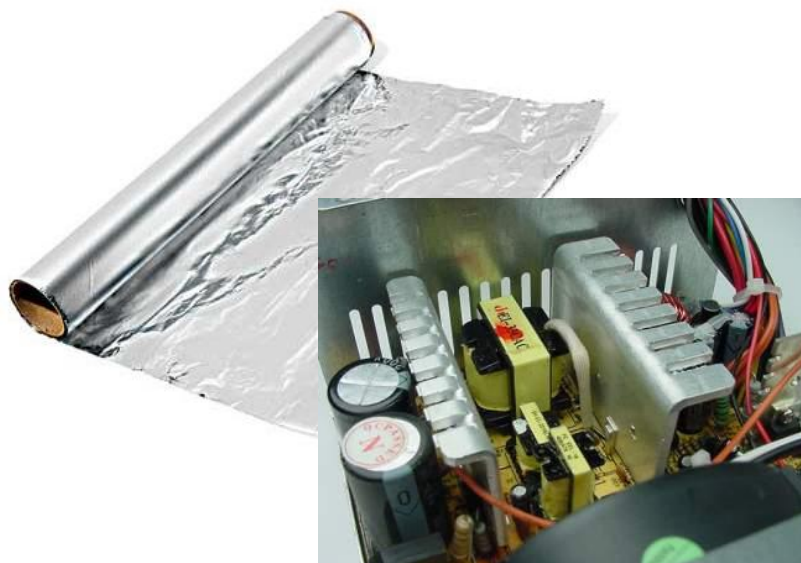
Figura 3 – Blindando a fonte chaveada.
