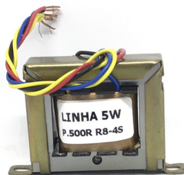
Figura 16 – Transformador para casamento de impedância.
