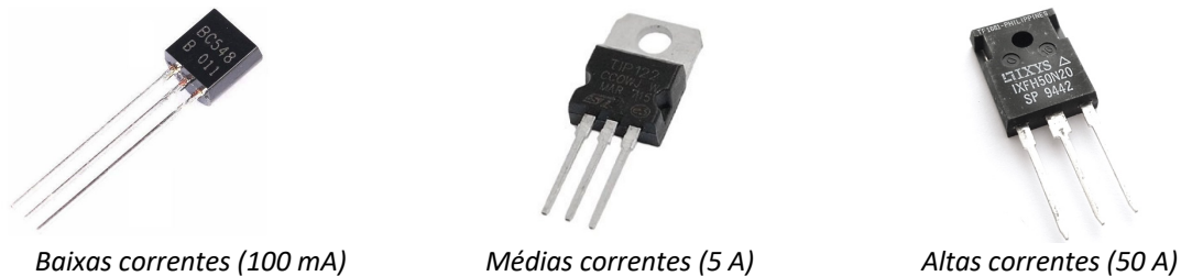
Figura 16 – Transistores comuns disponibilizados comercialmente.
