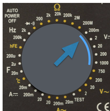
Figura 4 – Escala de tensão em corrente contínua.
