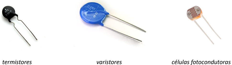
Figura 10 – Resistores com diversas finalidades.
