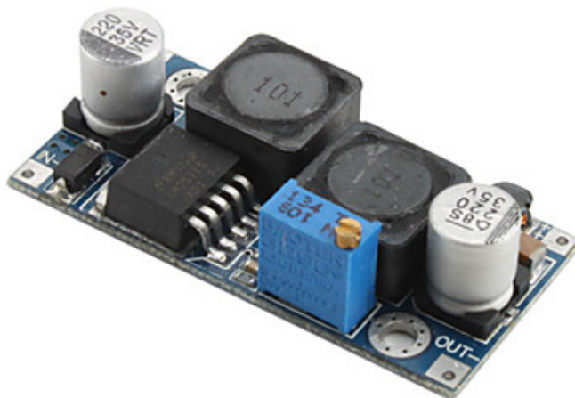
Figura 1 – Exemplo de conversor cc-cc Buck-Boost comercial.
