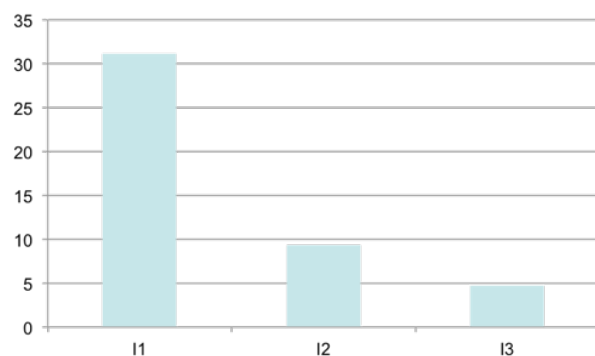
Figura 18 – Exemplo de chuveiro com controle de temperatura por controle de ângulo de fase e conteúdo harmônico na corrente suprida da rede de energia elétrica.
