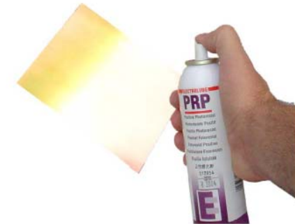
Aplicação do PRP (tinta fotosensível)
