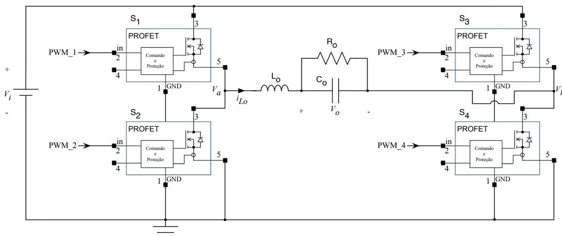
Figura 1 – Circuito do conversor cc-ca ponte completa.
