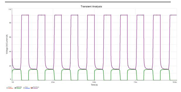
Figura 20 – Formas de onda de tensão e corrente na chave.
