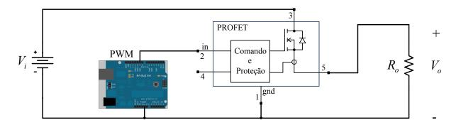
Figura 24 – Circuito do conversor cc-cc.
