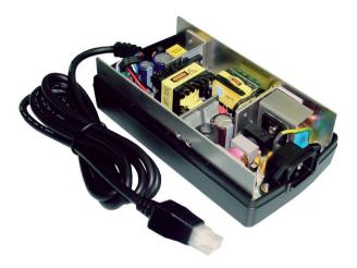
Figura 10 – Exemplo de fonte chaveada comercial.
