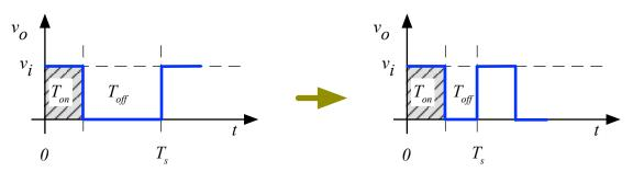
Figura 15 – Formas de onda para modulação por frequência variável (PFM).
