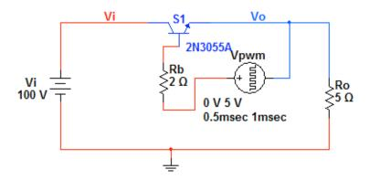
Figura 18 – Circuito simulado no Multisim.
