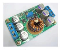
Figura 3 – Exemplo de conversor cc-cc comercial.
