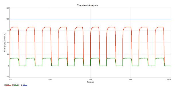
Figura 19 – Formas de onda da tensão de entrada e de saída e da corrente na carga.
