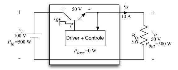
Figura 9 – Solução do problema empregando conversores cc-cc chaveado.
