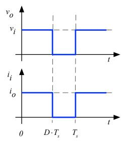
Figura 12 – Formas de onda do conversor cc-cc simples.
