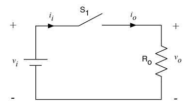
Figura 11 – Circuito de um conversor cc-cc simples.
