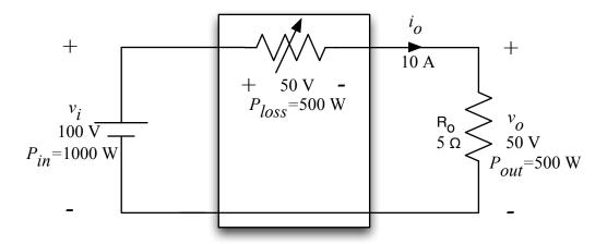
Figura 6 – Solução do problema empregando resistores.
