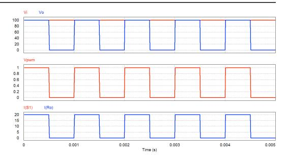
Figura 17 – Principais formas de onda do conversor cc-cc simples com componentes ideias.
