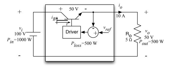
Figura 7 – Solução do problema empregando conversores cc-cc linear.
