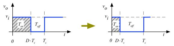
Figura 14 – Formas de onda para modulação por largura de pulsos (PWM).
