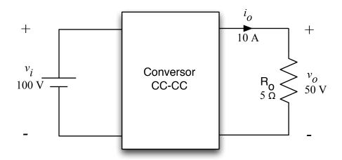
Figura 5 – Aplicação típica de um conversor cc-cc.
