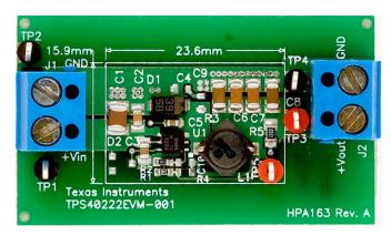
Figura 1 – Exemplo de conversor cc-cc Buck comercial.
