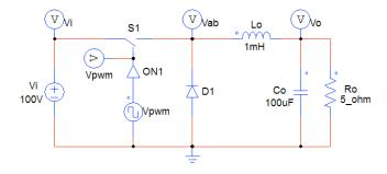
Figura 19 – Circuito simulado no Psim.
