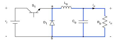
Figura 4 – Segunda etapa de operação do conversor Buck (CCM).
