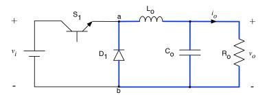
Figura 13 – Segunda etapa de operação do conversor Buck (DCM).
