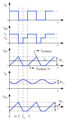
Figura 15 – Formas de onda do conversor cc-cc
