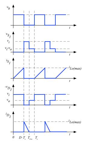
Figura 16 – Formas de onda do conversor cc-cc
