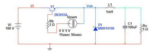
Figura 22 – Circuito simulado no Multisim.
