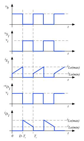
Figura 6 – Formas de onda do conversor cc-cc Buck em condução contínua.
