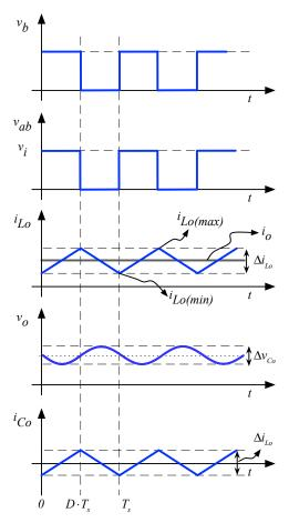
Figura 5 – Formas de onda do conversor cc-cc Buck em condução contínua.
