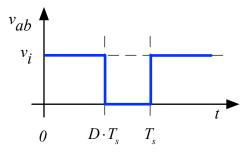
Figura 7 – Forma de onda da tensão entre os pontos "a" e "b".
