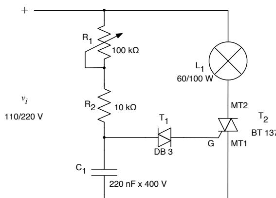
Figura 1 – Conversor ca-ca (gradador com tiristores).
