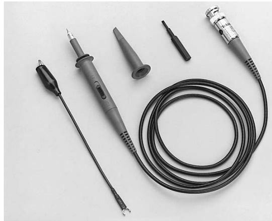
Figura 18 – Sonda de tensão utilizada.
