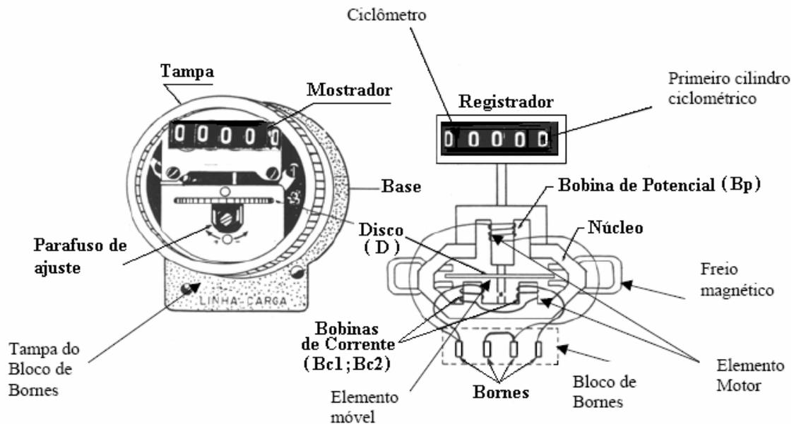
Figura 2 – Esquema básico do medidor de energia
