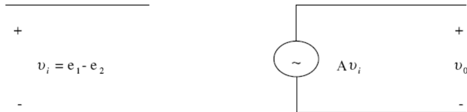
Figura 2 - Representação do AMPOP por fonte independente de tensão.
