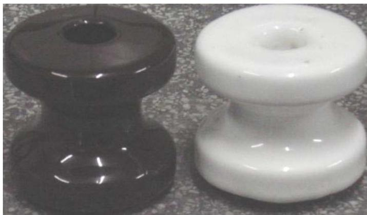
Figura 4.24 – Isolador comercial e protótipo obtido
