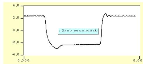
Fig. 5.40 - Forma de onda de tensão [V] quadrada no tempo induzida no quadro de Epstein, atenuada por um fator 2, na frequência de 130 [Hz] e uma indução máxima de 0,8 [T].
