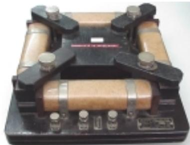
Fig. 4.1 - Quadro de Epstein utilizado tipo B-EP-25cm (1968), da marca Yokogawa Electric Works Ltda.
